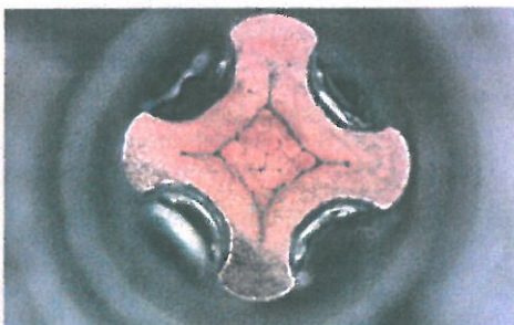
Schliffbild eines guten Crimps
